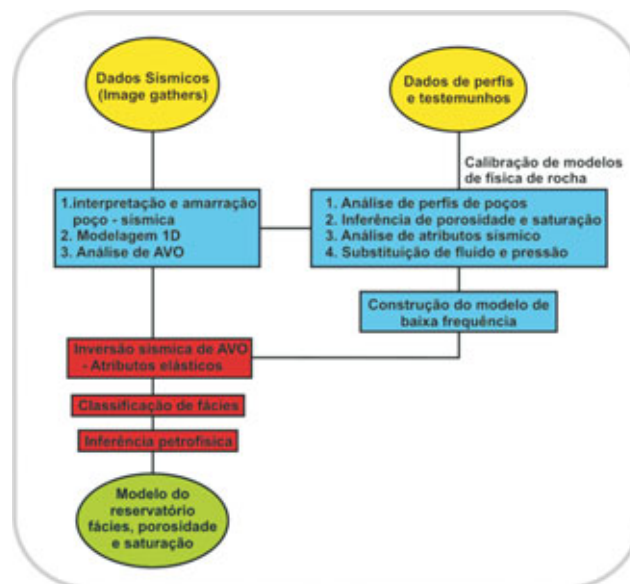
Fig. 1: Fluxo de trabalho para inferência de propriedades de reservatório a partir da integração de dados sísmicos migrados e abertos (em tempo ou profundidade) e dados de perfis e testemunho.
