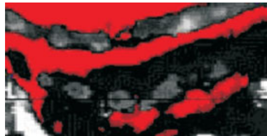
Fig. 5: Resultado da inferência de saturação. A região em vermelho representa os pontos onde a probabilidade da saturação de água ser menor que 0,3 é maior que 0,95.
