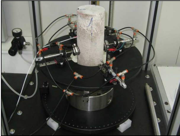
Figura 2 – Fotografia do equipamento utilizado nos ensaios de VelAn em testemunhos.
