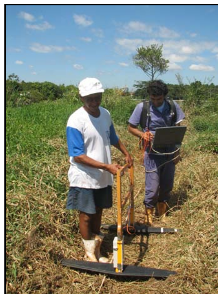
Foto 4 - Levantamento GPR (antena de 100 MHz) na área assoreada.
