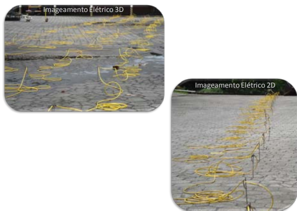
Figura 1 – Disposição dos cabos multi-eletrodos nos imageamentos elétricos 3D e 2D.
