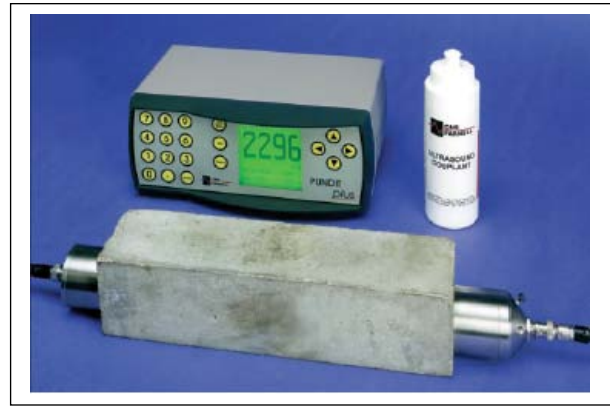
Figura 1 – Ilustração do PUNDIT (Portable Ultrasonic Non-Destructive Integrity Tester).
