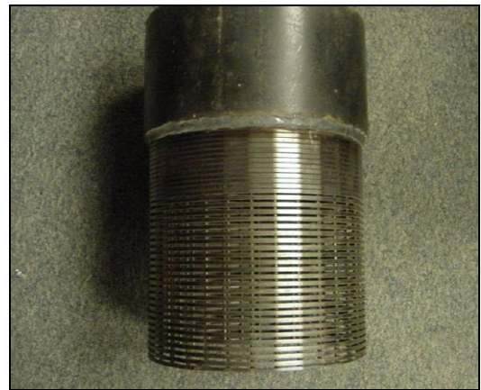
Figura 5. Detalhe do filtro espiralado. Os espaçamentos são para a penetração da água no poço quando os filtros são colocados nas camadas produtoras, (Júnior G. C. S, 2008).
