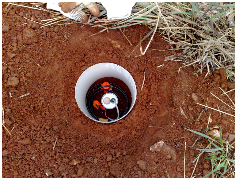
Figura 2 – Foto do geofone e do registrador Texan instalados dentro da perfuração e protegidos pelo tubo de PVC.
