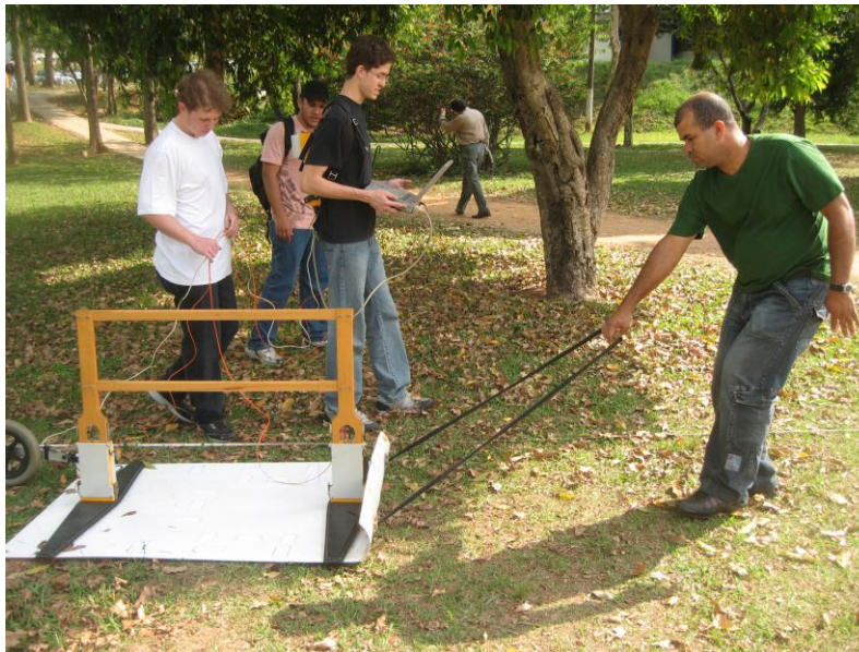
Figura 3. Aquisição GPR com antenas de 100 MHz sobre o trenó de PVC, modo contínuo, arranjo EyEy.
