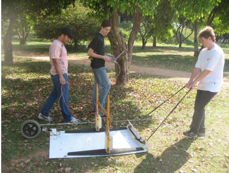
Figura 2. Aquisição GPR com antenas de 100 MHz sobre o trenó de PVC, modo contínuo, arranjo ExEx.
