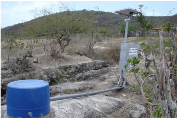
Figura 1- Estação SOJO. O sismômetro encontra-se dentro do recipiente azul. O registrador encontra-se dentro da caixa cinza.
