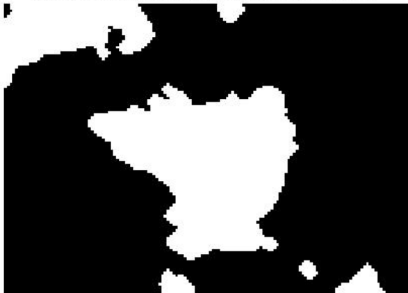
Figura 6: Imagem TM (Banda 4) na forma binária e erodida sofre uma dilatação pelo mesmo elemento estruturante. Nota-se na figura que o efeito da abertura (erosão seguida por dilatação) foi aumentar as fronteiras, das regiões de interesses, que sofreram erosão
