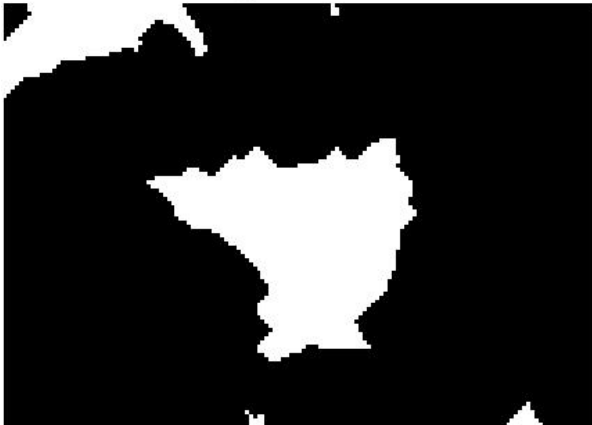
Figura 5: Imagem TM (banda 4) na forma binária e erodida. Nota-se na figura que o efeito da erosão foi eliminar pequenos pontos na imagem limiarizada, que não estão associados ao tipo de estrutura procurada.
