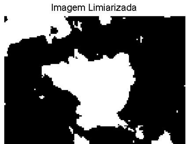
Figura 4: Nesta figura, mostra-se a imagem TM binarizada (banda 4) de uma região de Savanas, com baixa cobertura Vegetal. Nota-se o efeito da limiarização isolando, neste caso, as regiões espectralmente menos ativas na imagem-banda.
