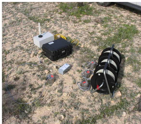
Figura 2: Na esquerda os três cabos junto com os sensores verticais, no centro o sensor triaxial e mais em cima o data log . Fonte: www.nanoseismic.net .
