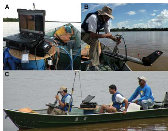
Figura 6: Equipe de pesquisadores do IPT em operação de aquisição de dados no rio Araguaia. A) detalhe do sistema de gerenciamento da aquisição de dados (notebook e central de controle da fonte acústica); B) a fonte acústica; C) embarcação de pequeno porte em operação.
