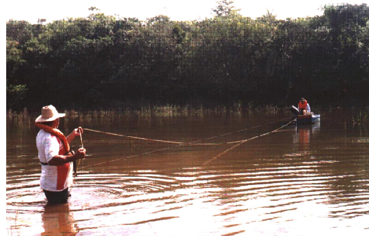
Figura 3: Foto da aquisição dos dados de Georadar com barco na represa Serra Azul. Observa-se no primeiro plano o ajudante segurando a corda para guiar o barco obtido com antena de 100 MHz. Observa-se a múltipla do fundo do lago.
