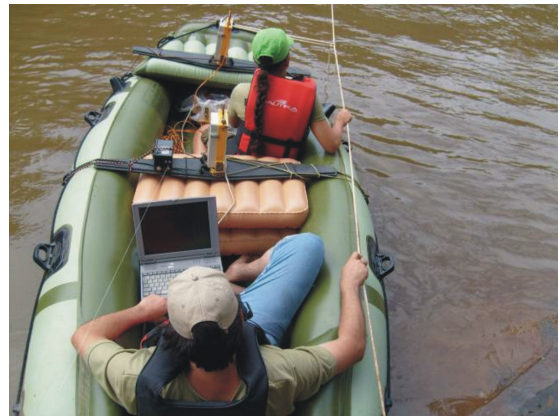
Figura 3 – Barco montado com o equipamento para adquirir os dados sobre o rio.
