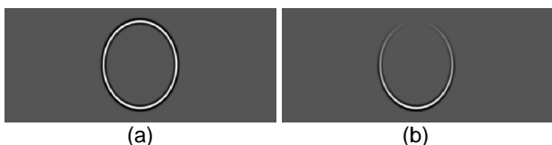
Figura 2. Campos de ondas: completo (a) e descendente (b), propagando-se no interior de um modelo homogêneo com a fonte posicionada no centro do modelo.
