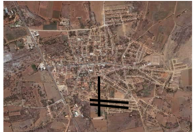
Figura 11 – Posicionamento dos sublevantamentos gravimétricos/eletrorresistivos na zona periurbana de Lapão.
