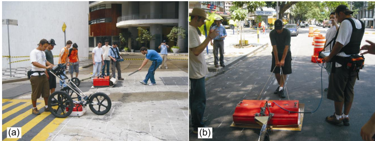
Figura 2. Fotos da aquisição GPR na Av. Ipiranga junto ao Ed. Copan. a) antenas de 400 MHz (primeiro plano) e 200 MHz (ao fundo) no bloco-1. b) antena de 100 MHz no bloco-2.
