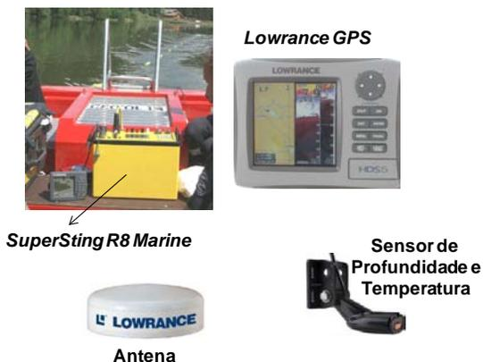
Figura 3 – Resistivímetro (**Super Sting R8/IP**), GPS (**Lowrance**), antena do GPS e sensor de profundidade e temperatura.
