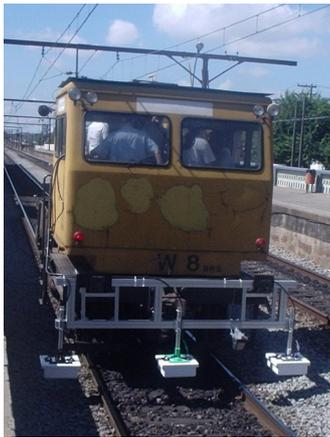
Figura 01: Antenas GPR e sensor Doppler instalada em um veículo ferroviário de inspeção de via.
