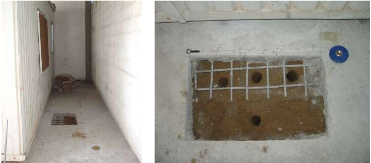
Figura 8 – Posição do corte na laje (esquerda). Furos de trado efetuados no substrato arenoso (área anômala sob o piso de concreto; direita).
