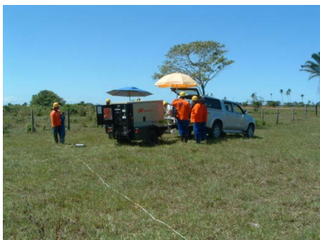
Figura 1 – Sistema transmissor com espira, moto-gerador e unidades de transmissão e controle (no veículo).
