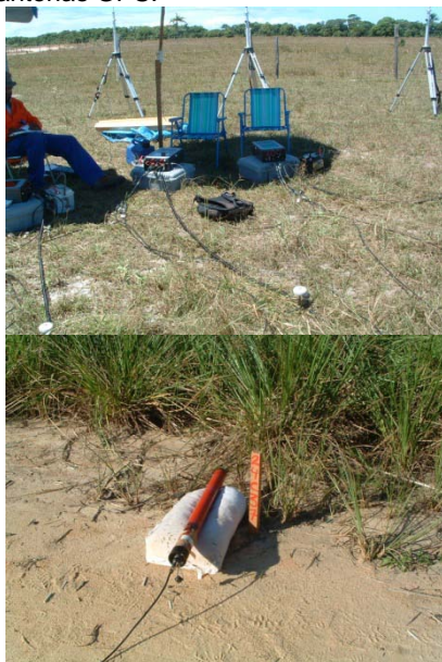
Figura 2 – Unidades de recepção mod. V8, com três canais para medidas de campo magnético via bobinas.
