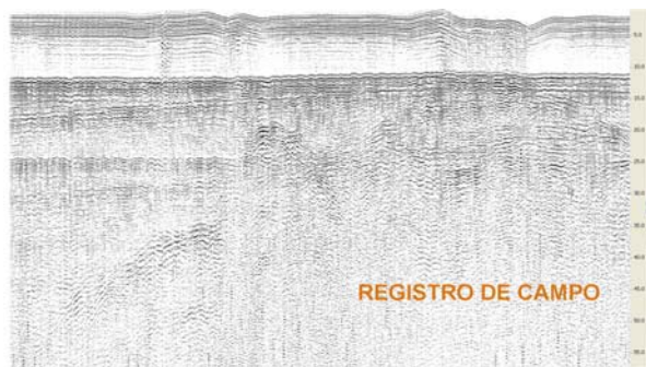
Fig. 8: Registro sísmico obtido com fonte acústica do tipo boomer mostrando o poder de penetração desta fonte, que neste exemplo detecta o embasamento rochoso a profundidade superior a 50m. (IPT, 2010).
