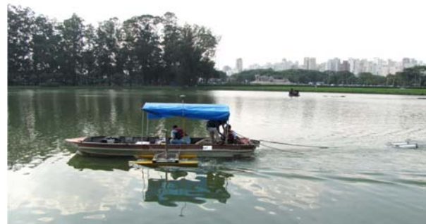
Fig. 1: Embarcação de pequeno porte executando levantamento geofísico em lago urbano da cidade de São Paulo.
