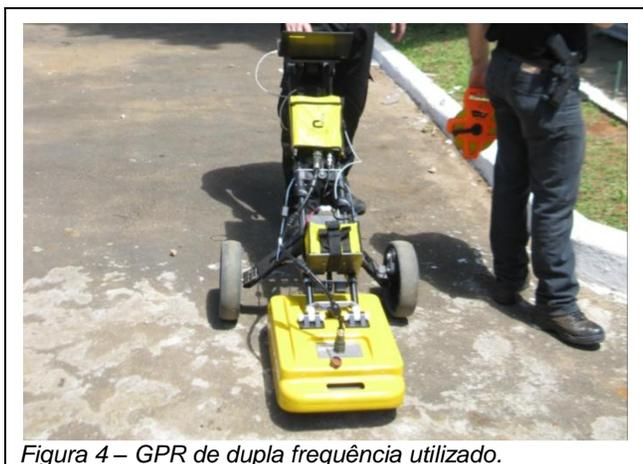
Além de processamento bidimensional (seção por seção), o conjunto de dados GPR realizado com a mesma antena foi posicionado e interpolado, possibilitando a geração de um novo conjunto de dados, agora com informação tridimensional (3D) do subsolo para a área.
