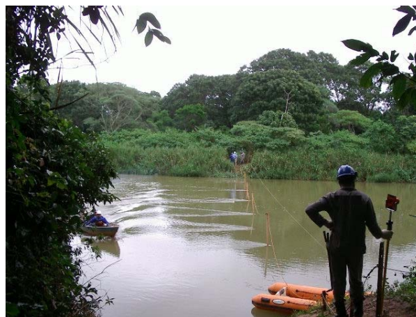
Figura 3 – Foto do levantamento de imageamento elétrico realizado ao longo da travessia do rio Piraque-Açu, no município de Aracruz / ES.
