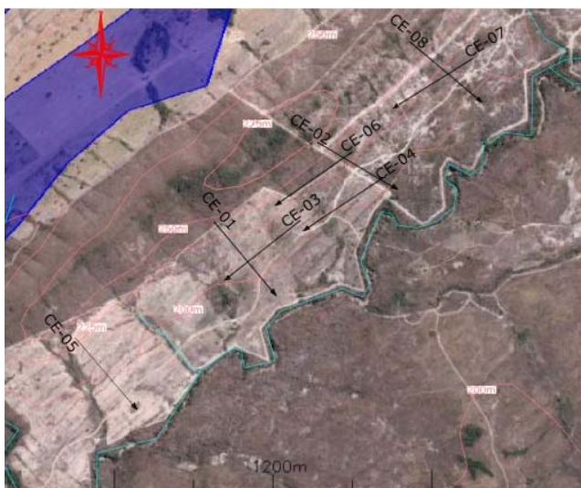
Figura 3 – Em preto a distribuição de linhas de levantamento geofísico, em vermelho claro as linhas de topografia e azul as linhas de drenagem.
