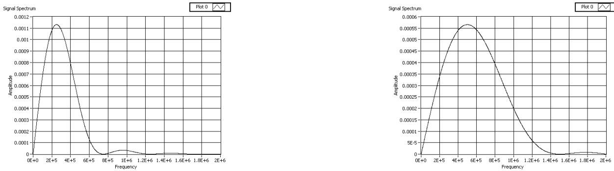
Figura 8 – Espectro de freqüências das formas de onda utilizadas para excitar o transdutor fonte. Esquerda 250KHz, direita 500KHz
