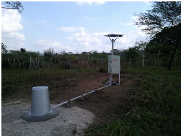
Figura 2- Estação em operação em São Caetano - rede SO2010. O sismômetro encontra-se dentro do recipiente cinza. O registrador encontra-se dentro da caixa cinza.
