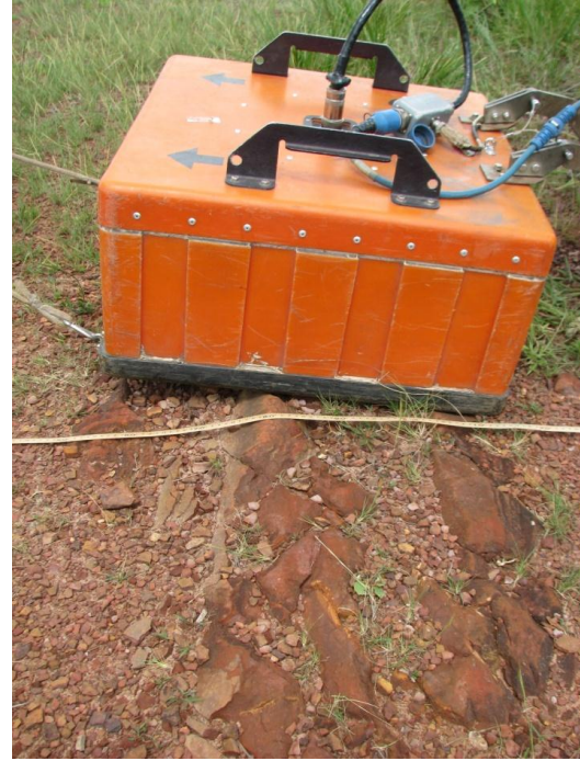
Figura 03 – Foto evidenciando a aquisição de dados de GPR perpendicular ao mergulho verdadeiro das camadas de quartzito.
