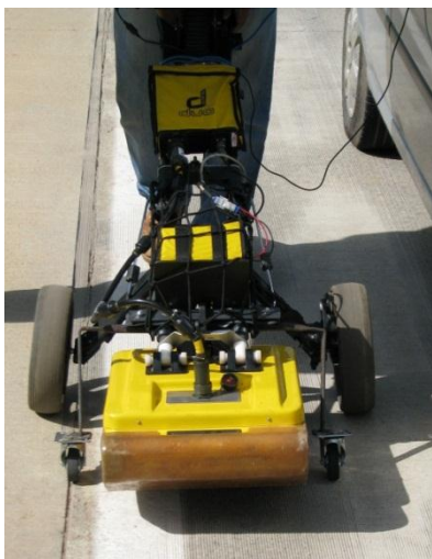
Figura 5 - Foto mostra o equipamento Detector Duo com antenas blindadas de 250 MHz e 700 MHz, utilizados para aquisição de dados de GPR na faixa de segurança da rodovia.
