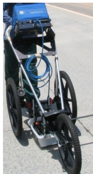
Figura 4 – Foto mostra o equipamento SIR 3000 com antena blindada de 900 MHz, utilizados para aquisição de dados de GPR na faixa central da rodovia.
