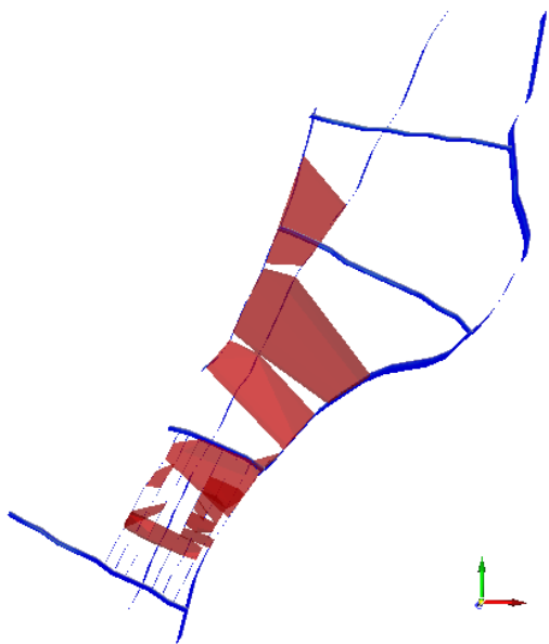
Figura 9. Distribuição espacial das paleocavernas do afloramento de Quixeré identificadas nas seções GPR.
