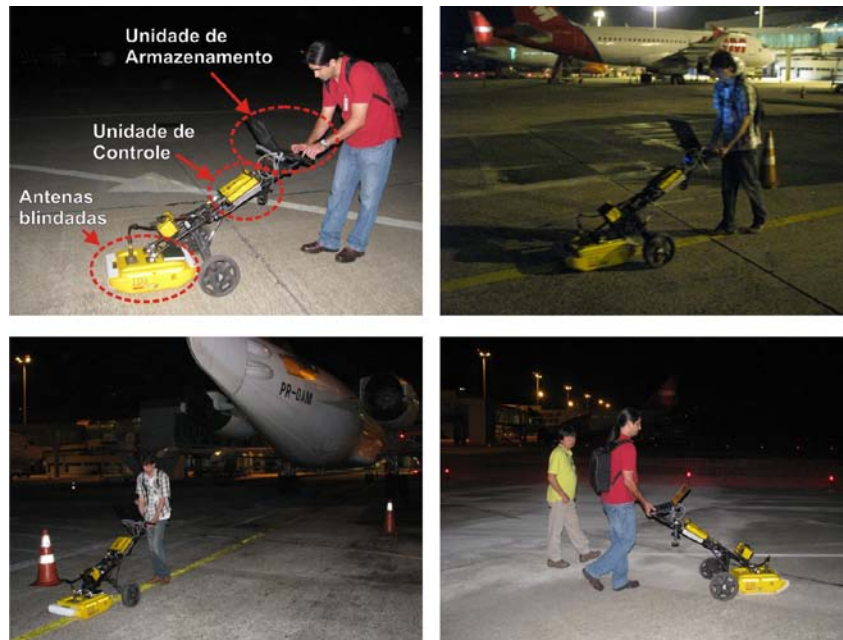
Figura 3 – Fotografias evidenciam a aquisição de dados de GPR no pátio de manobras de aeronaves do Aeroporto Santos Dumont, Rio de Janeiro/RJ.
