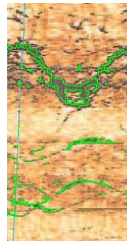
Figura 5 - Composição colorida da imagem do perfil de poço, com a sobreposição do contorno das fraturas obtidos apartir da metodologia proposta.
