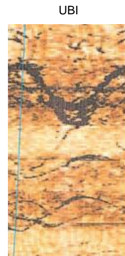
Figura 1 - Perfil de imagem obtido através da ferramenta UBI. (Adaptado de Akibar)
