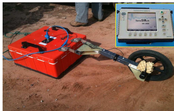
Figura 4: Fotografia evidencia o equipamento GPR utilizado no estudo.
