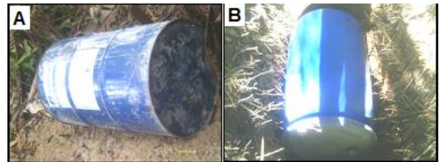
Figura 4 – Tambores enterrados no Campo de Testes. (A) Tambor metálico revestido com pintura; (B) Tambor plástico.
