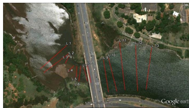
Figura 1 – Croqui com a localização das linhas de GPR adquiridas nas proximidades da Ponte do Braguito, Lago Paranoá.
