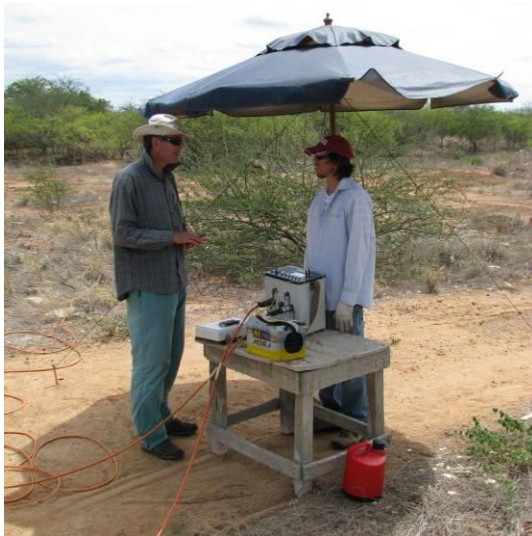
Figura 03: Foto evidência a aquisição de dados de eletrorresistividade na área da Univasf, Petrolina/PE, com o equipamento SYSCAL PRO.
