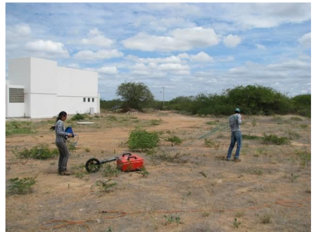
Figura 04: Foto evidência a aquisição de dados de GPR na área da UNIVASF, Petrolina/PE.
