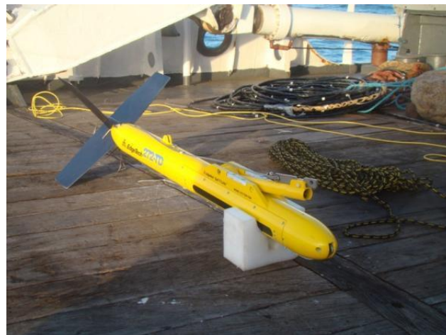
Figura 3. Sonar de Varredura Lateral da EdgeTech modelo 272-TD.
