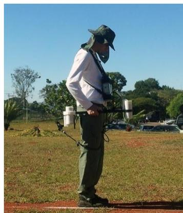
Figura 6 - Gradiômetro Posicionado na Horizontal ( $G_y$ )
