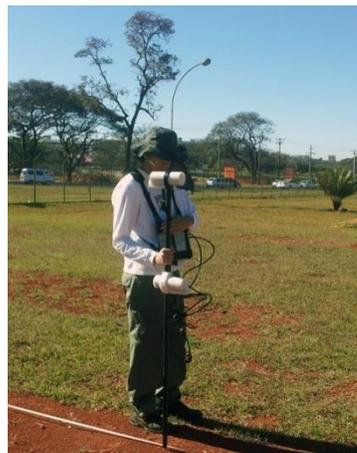
Figura 5 - Gradiômetro Posicionado na Vertical ( $G_z$ )
