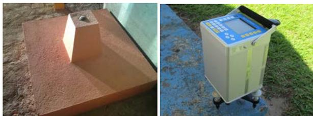
Figura 2: Marco gravimétrico do IBGE à esquerda e detalhe do gravímetro CG-5 à direita.
