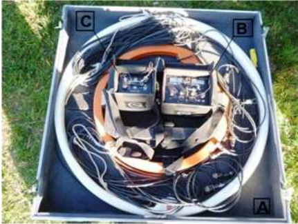
Figura 1 - Equipamento EM34-3XL, A) Bobina de transmissão (branca) e de recepção (laranja); B) Módulo Receptor; C) Módulo Transmissor.
