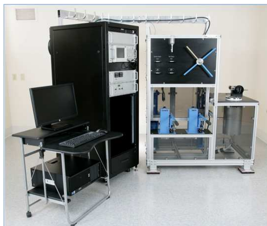
Figura 4 - Sistema Autolab500 ® usado para a medição das propriedades elásticas das rochas.
