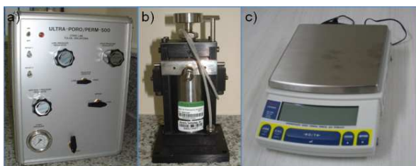
Figura 3 - a) Permoporosímetro; b) Matrix cup ; c) Balança semi-analítica.
