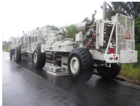
Fig. 3 Exemplo de Vibro em operação em estrada de asfalto na área de estudo
