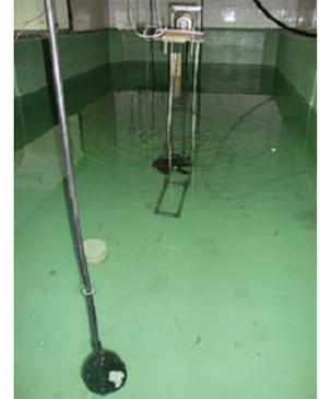
Figura 2 – a) Protótipo do hélice. b) O hélice junto com o hidrofone imersos no tanque do IAPM.
