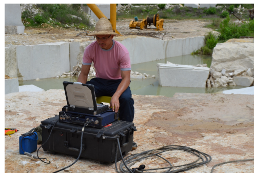
Figura 7: Sistema SIR-II da GSSI utilizado na aquisição com uma antena de 200 MHz.
