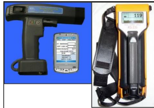
Figura 2 Sonda multiparâmetro MPP-EM2S+ para medição da susceptibilidade magnética; Gamaespectrômetro portátil RS-230;
