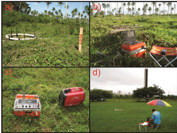
Figura 4 - Equipamentos utilizados em uma sondagem TDEM. (a) bobina receptora; (b) pumpking ; (c) transmissor e gerador; (d) equipamento complet
