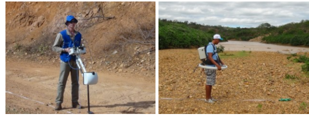
Figura 2: Equipamento PROMIS-10: a) monitor e receptor-Rx; b) bobina e transmissor-Tx e baterias no cinturão, onde são gerados os campos primários. Transmissor e receptor estão conectados por cabo de transmissão de dados.
