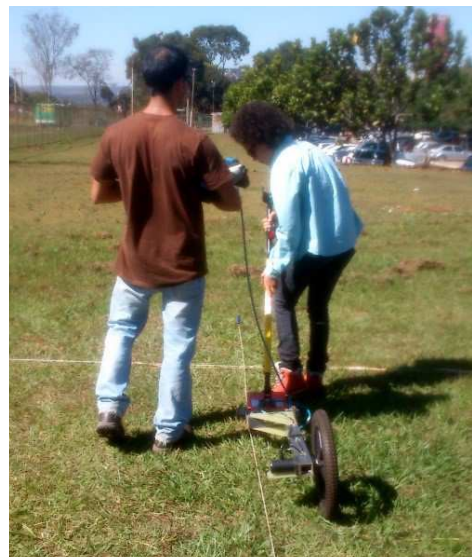
Figura 2: Foto evidenciando a aquisição de dados GPR com a antena de 900MHz na área do SITCRIM.
