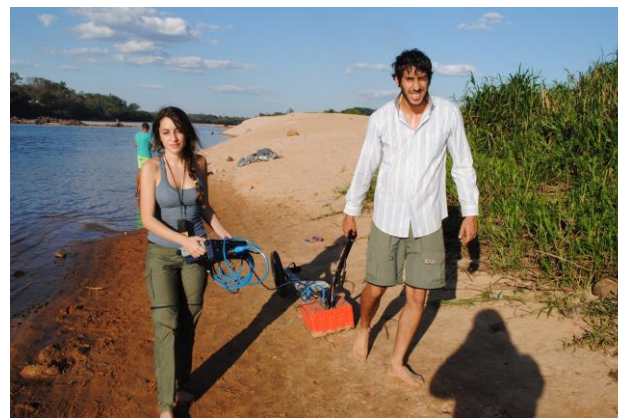
Figura 1 – Foto evidencia a aquisição de dados de GPR em uma praia, usando-se o sistema SIR3000 com antena de 400MHz.
