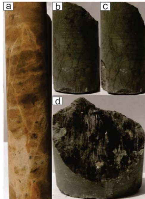
Figura 3 - (a) Arenito falhado pertencente a fácies LTF 3, com a presença de falhas formando barreiras à migração de fluidos internamente a rocha. (b) e (c) Migração de óleo ao longo dos planos de ruptura identificados ao longo da fácies LTF 4. (D) Plano de falha preenchido por óleo de elevada viscosidade, presente na fácies LTF 4.
